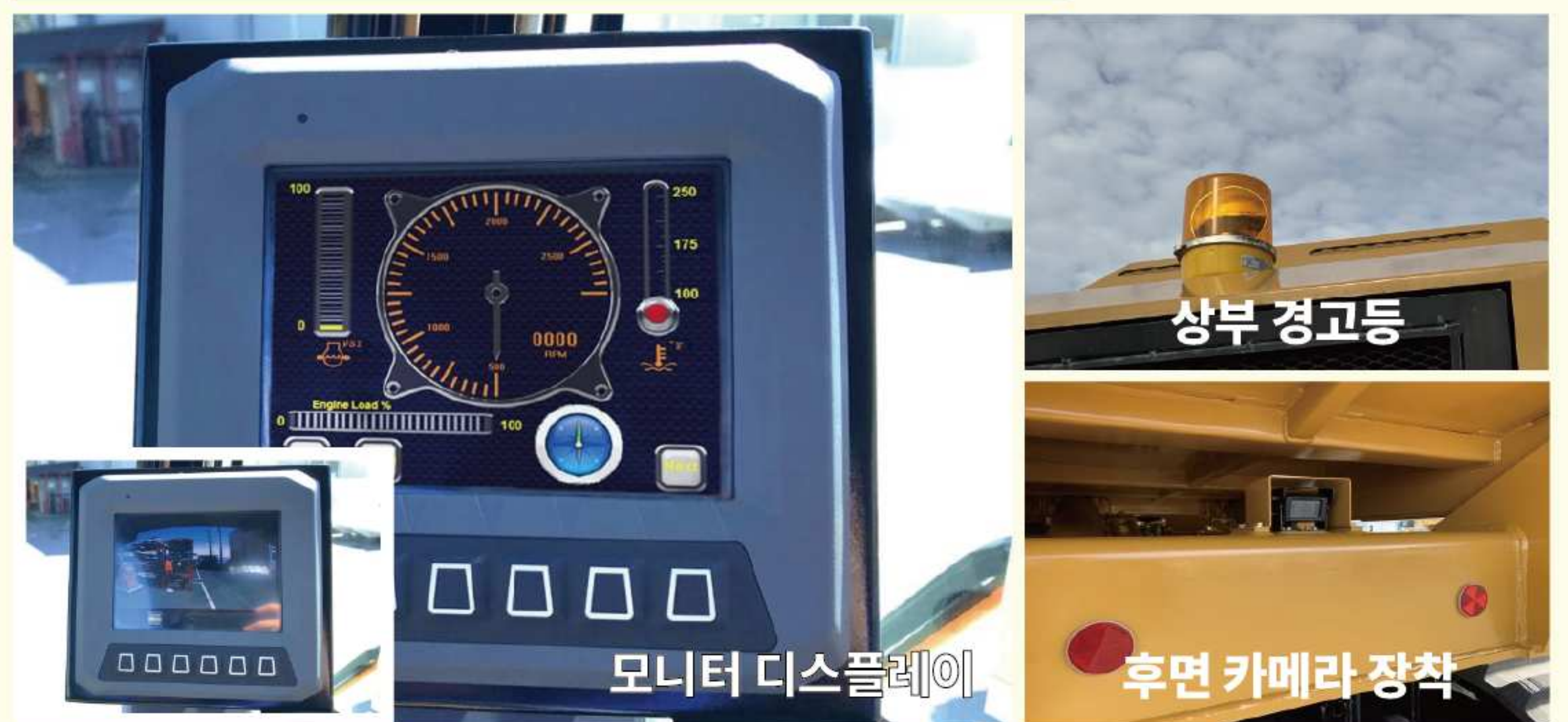
연료량, 엔진 회전, 문제 발생 시 주의 램프 점등 등 장비 상태 쉽게 확인
