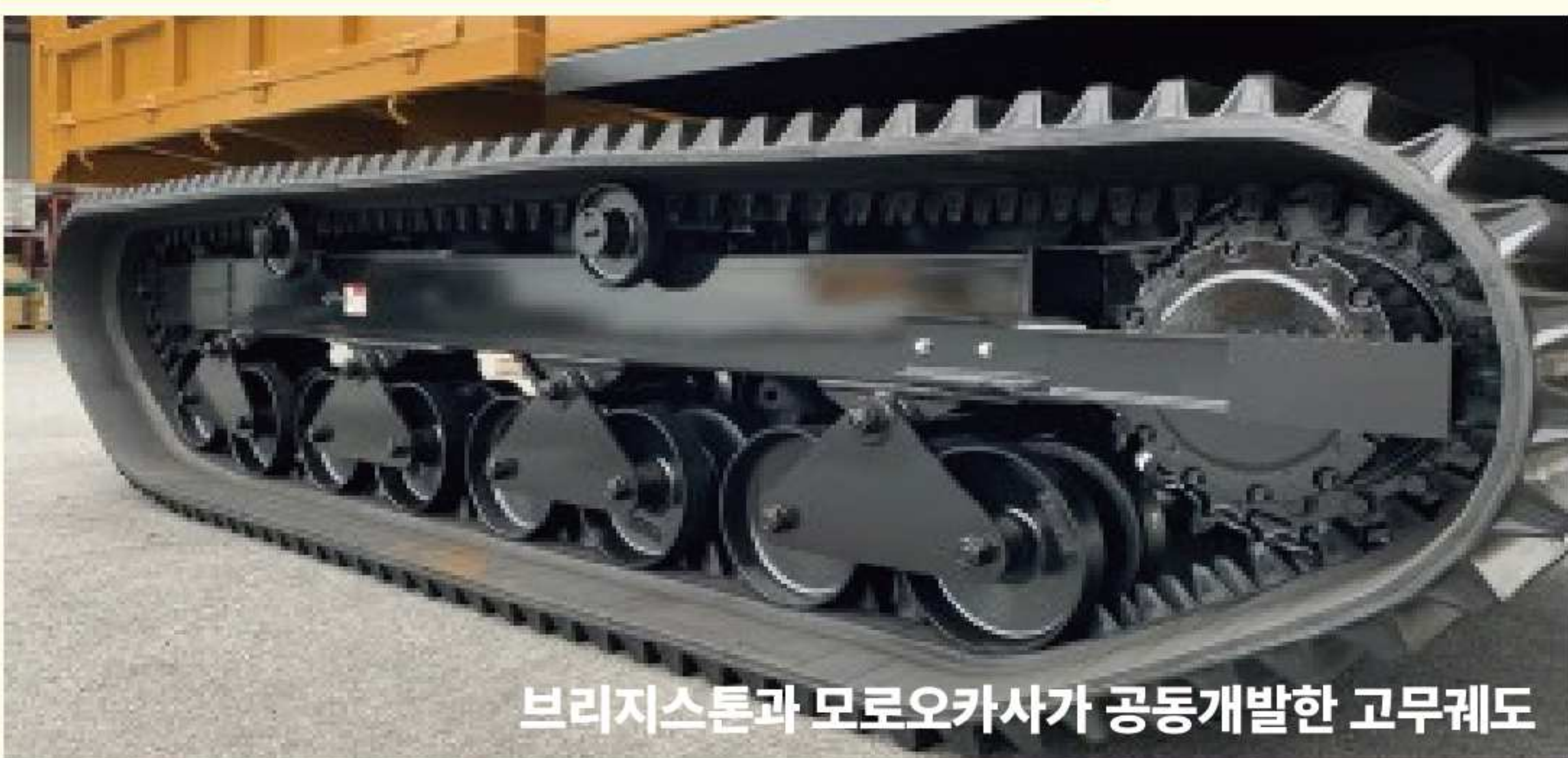
HST시스템으로 구동된 고무크롤러는 뛰어난 내구성과 부드러운 주행
